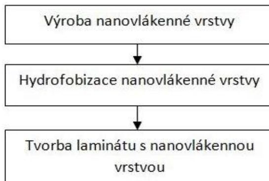
Obr. 2: Schéma postupu výroby laminátu s nanovlákněnou vrstvou
