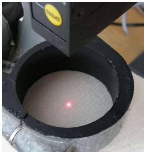
Obr. 5. Měření vydutí vzorku laserovým snímačem [75].
