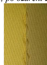
Obr. 36 Bavlněná tkanina obarvená kypovým barvivem C. I. Vat Yellow 2 (1 % vybarvení; bez ozáření; po ozáření 2,98 J.cm -2 )
