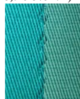
Obr. 34 Bavlněná tkanina obarvená kypovým barvivem C. I. Vat Green 1 (1 % vybarvení; bez ozáření; po ozáření 2,98 J.cm -2 )
