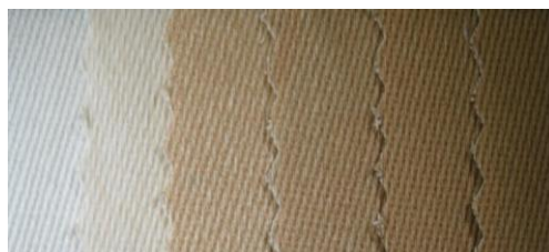
Obr. 32 Neobarvený vzorek bavlněné tkaniny nezářený a ozářený různou plošnou hustotou energie laserového paprsku (0,99; 1,99; 2,98, 4,97 a 6,96 J.cm -2 )
