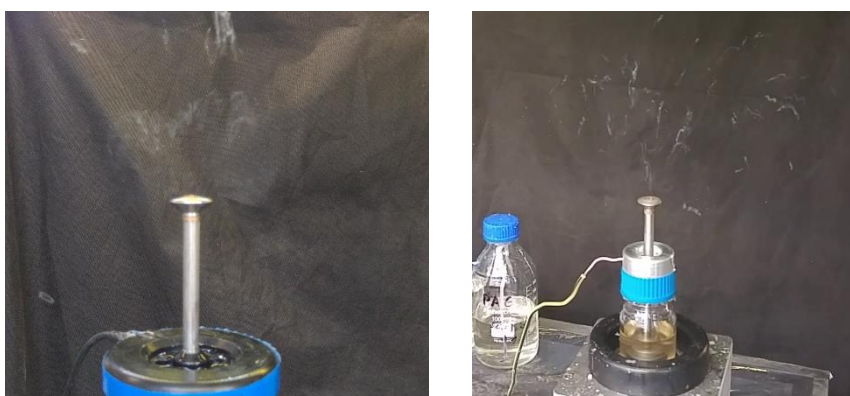
Obr. 20 – Příklady zvláknování PA 6 roztoku pomocí přeplavovacích elektrod
