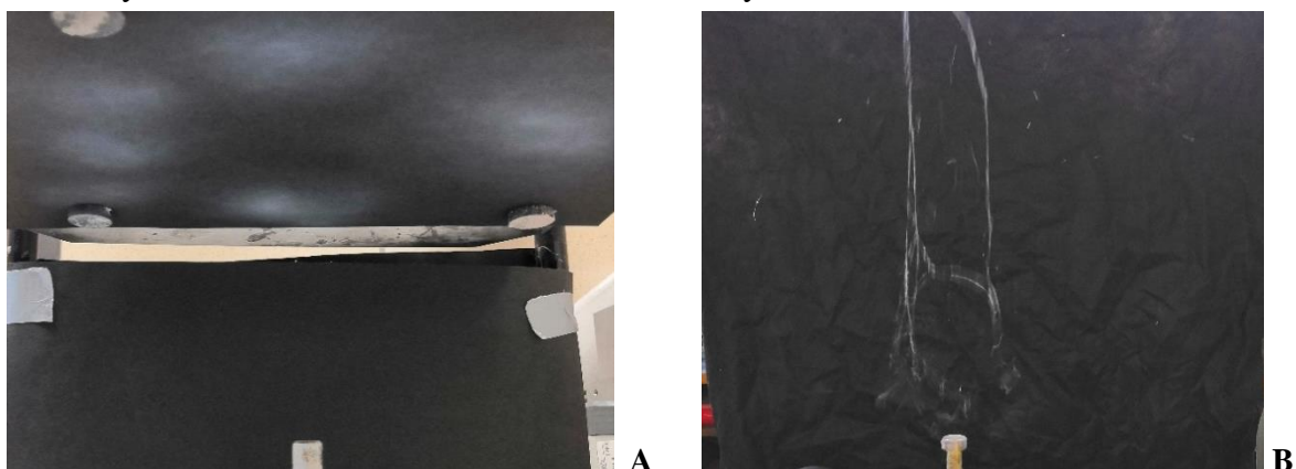
Obr. 12 – Zvláknování základního roztoku PA6 z kapky pomocí DC zdroje (A) a srovnání se zvláknováním pomocí střídavého proudu (B)
