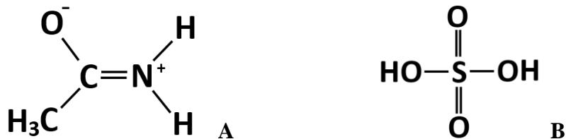
Obr. 8 – Rezonance amidové vazby, která je součástí PA 6 (A). Příklad kyseliny (B) sloužící jako aditivum, konkrétně H_2SO_4 s vysokou disociací prvního i druhého stupně ve vodném prostředí
