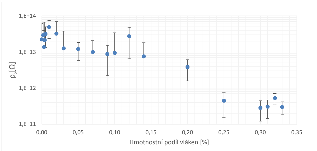
Obr. 5.8 Povrchový odpor kompozitů plněných recyklovanými uhlíkovými vlákny
