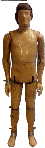
Figure 5a. Tore - Dry thermal manikin
