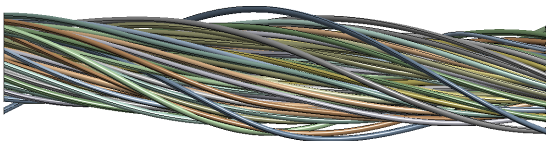
Obr. 7.9 Importovaný 3D model vlákenné příze do MKP programu
