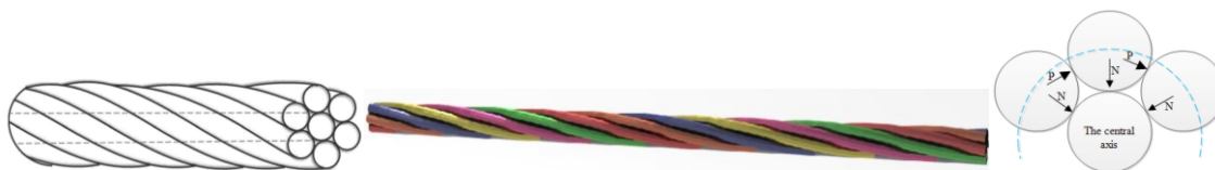
Obr. 2.4 Struktura zakroucené multifilamentové příze [41]
