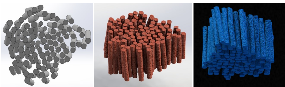
Obr. 7.6 Vytážený 3D model soustavy vlákně příze (vlevo), izometrický náhled na sestavu vláken (uprostřed), izometrický náhled na vznikající zákrut (vpravo)
