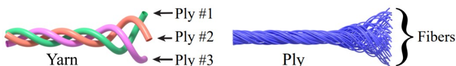
Obr. 2.8 Příkladů modelů pro splétané vzorky příze
