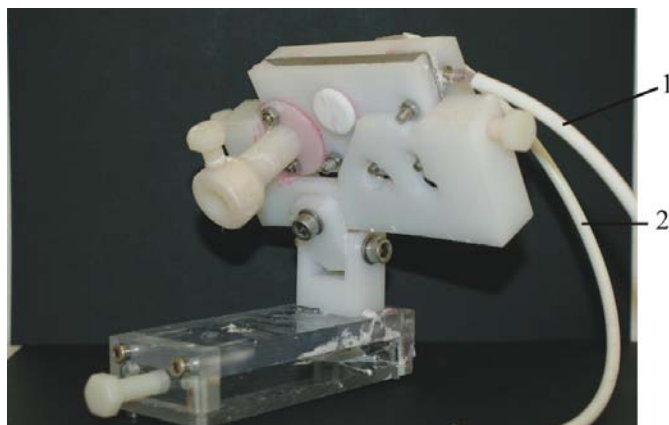
Obr. 4: Přepřelavovací hladinový koaxiální elektrosponer, (1) přívod vnitřní komory, (2) přívod vnější komory.
