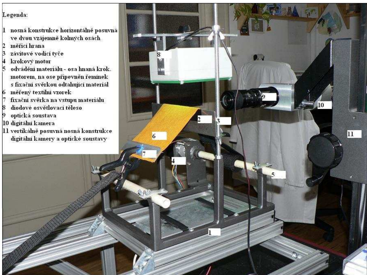
Obr. 3: Detail rámu-nosné konstrukce s polohově nastavitelnými komponenty
