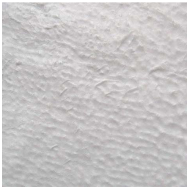
Obrázek 4 - Nanovláknenná vrstva ze solu J18, poloprovozní zvláknování. (digitální fotoaparát, skutečná velikost)
