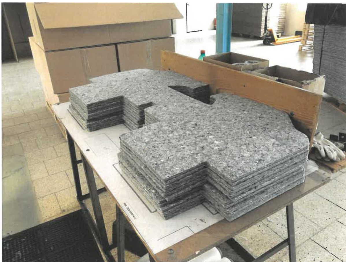
Obr. č. 5.: Vyseknuté polotovary připravené k uložení do krabic (za odkládacím stolem) a následnému uskladnění.
