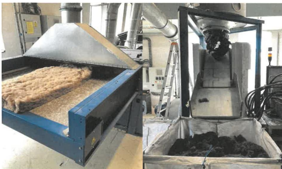
Obr. č. 2.: Vložený materiál prochází soustavou ozubených válců, rozmělněný materiál je vzduchem poháněný do trhacího bubnu a následně samovolně padá do připraveného pytle.
