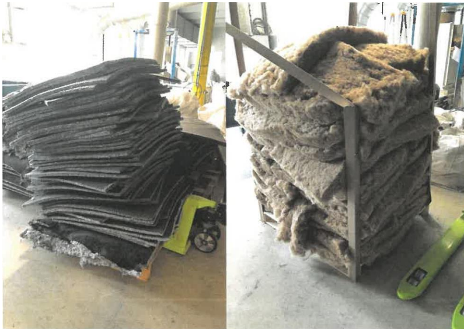
Obr. č. 1. Materiál ve formě nepovedených výrobků. Vlevo — z bavlněných vláken. Vpravo ze lněných, jutových a dalších vláken.
