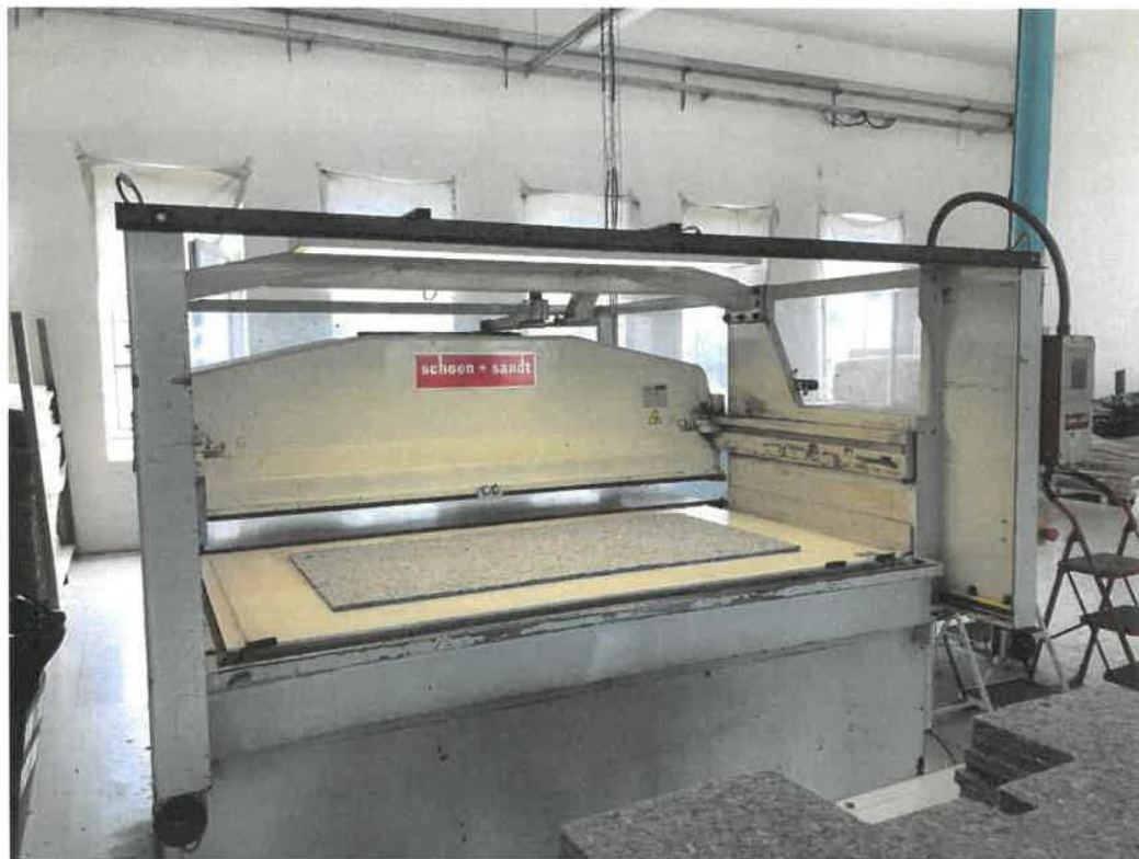
Obr. č.4 - Vysekávací stroj s připraveným materiálem.
